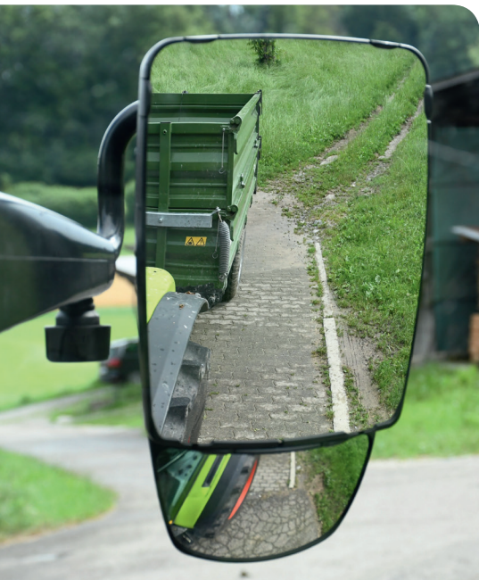
Ein zusätzlicher Weitwinkelspiegel zeigt den Bereich unmittelbar neben dem Hinterrad.
