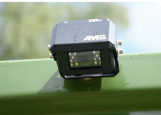
Eine Rückfahrkamera mit Nahsichtfunktion unterstützt beim Rückwärtsfahren.
