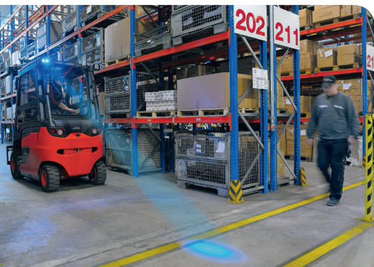
Zusätzliche Warnung von Personen im Gefahrenbereich durch eine Blue-Spot-Lampe (Bild: Linde MH)
