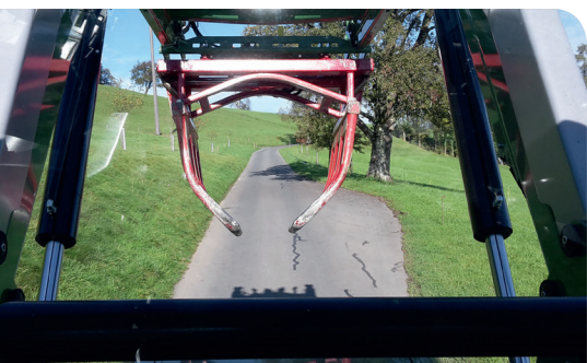
Der hochgestellte Frontlader verschlechtert das Sichtfeld massiv.
