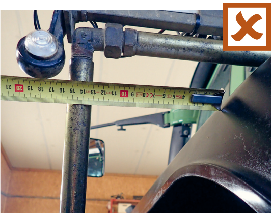
Abstand zwischen Leitungen und Radabdeckung
