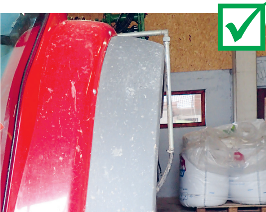
Die Radabdeckung überragt die Reifenflanke
