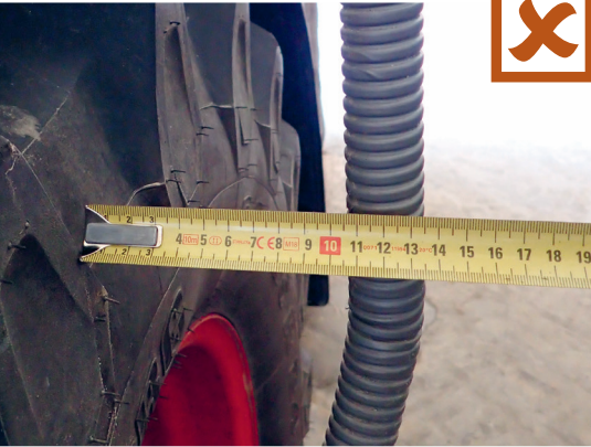
Überstand gegenüber Fläche der Reifenflanke > 100 mm
