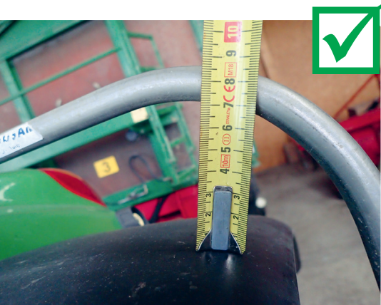
Die Radabdeckung überragt die Reifenflanke
